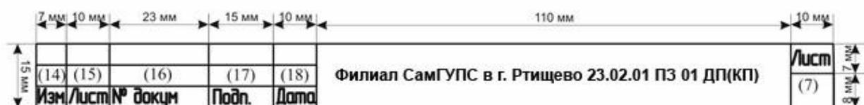
Рис. 3. Основная надпись для чертежей (схем) и текстовых конструкторских документов (Форма 2а, последующие листы ГОСТ 2.104-68)
