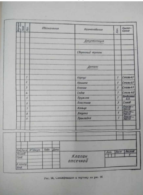
Рис. 95. Клапан отсечной, Сборочный чертеж
