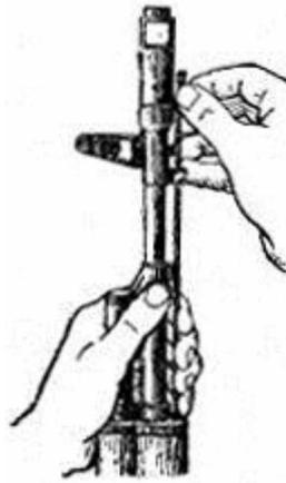
Отделить у автомата дульный тормоз-компенсатор. Утопить отверткой фиксатор дульного тормоза-компенсатора. Свернуть дульный тормоз-компенсатор с резьбового выступа основания мушки (со ствола), вращая его против хода часовой стрелки.
