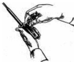
Отделить газовую трубку со ствольной накладкой. Удерживая автомат левой рукой, правой рукой надеть пенал принадлежности прямоугольным отверстием на выступ замыкателя газовой трубки. Повернуть замыкатель от себя до вертикального положения и снять газовую трубку с патрубком газовой каморы.
