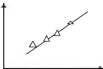
Теоретическая зависимость ёмкостного сопротивления  $X_C = \frac{1}{2\pi\nu C}$  обратно пропорциональна частоте электрических колебаний.
