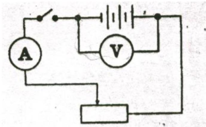
Установите ползунок реостата приблизительно в среднее положение, измерьте силу тока  $I_1$  и напряжение  $U_1$ .
