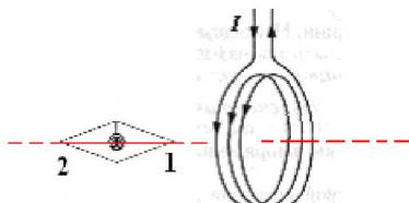
8. Вокруг катушки с током образовалось магнитное поле. Определите, какой из концов магнитной стрелки (верхний или нижний) расположенной в точке А является северным.
