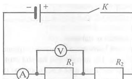
Замкнуть цепь ключом  $K$  и измерить силу тока  $I_1$  ( $A$ ) и напряжение  $U_1$  ( $B$ ) на концах первого резистора  $R_1$ . Вычислить сопротивление  $R_1$  ( $Om$ ):
