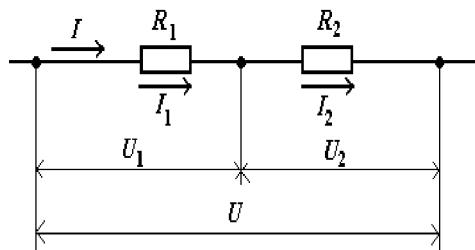
**3.** Какое из выражений верно для напряжения на концах участка цепи при последовательном соединении трех проводников с различными сопротивлениями?
