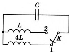
5. В начальный момент времени вся энергия, сообщённая колебательному контуру, была сосредоточена в конденсаторе и равнялась  $4 \cdot 10^{-6}$  Дж. Через  $\frac{1}{8}$  Т энергия на конденсаторе уменьшилась вдвое. Какой будет в этот момент времени энергия магнитного поля катушки?
