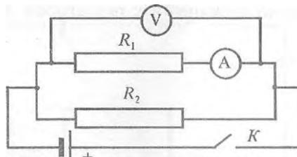
Замкнуть цепь ключом  $K$  и измерить силу тока  $I_1$  (A) и напряжение  $U_1$  (B) на концах первого резистора  $R_1$ . Вычислить сопротивление  $R_1$ (Ом):
