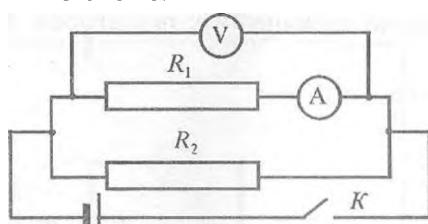
Замкнуть цепь ключом  $K$  и измерить силу тока  $I_1$  ( $A$ ) и напряжение  $U_1$  ( $B$ ) на концах первого резистора  $R_1$ . Вычислить сопротивление  $R_1$  ( $Om$ ):
