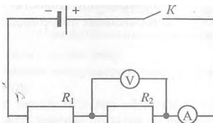
Замкнуть цепь и измерить силу тока  $I_2$  и напряжение  $U_2$  на концах второго резистора  $R_2$ . Вычислить сопротивление  $R_2$ .
