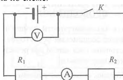
Замкнуть цепь и измерить силу тока  $I$  и напряжение  $U$  на концах последовательно соединенных резисторов. Вычислить сопротивление  $R$ .
