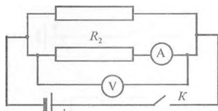
Замкнуть цепь и измерить силу тока  $I_1$  и напряжение  $U_2$  на концах второго резистора  $R_2$ . Вычислить сопротивление  $R_2$ .
