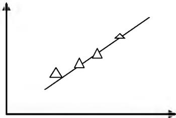
Теоретическая зависимость ёмкостного сопротивления  $X_C = \frac{1}{2\pi\nu C}$  обратно пропорциональна частоте электрических колебаний. Для экспериментальной демонстрации предлагается собрать на табло электрическую схему рис.4 (соединить на табло электрические контакты 1-4, 5-8)
