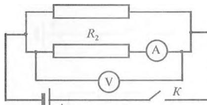
Замкнуть цепь и измерить силу тока  $I_2$  и напряжение  $U_2$  на концах второго резистора  $R_2$ . Вычислить сопротивление  $R_2$ .
