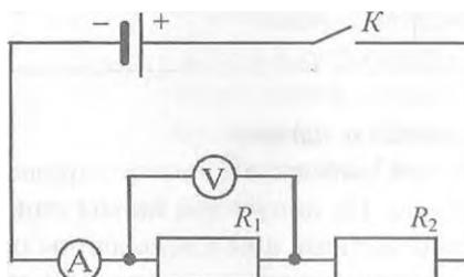
Замкнуть цепь ключом  $K$  и измерить силу тока  $I_1$  (A) и напряжение  $U_1$  (B) на концах первого резистора  $R_1$ . Вычислить сопротивление  $R_1$ (Ом):
