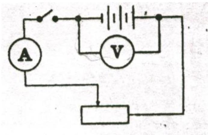
Установите ползунок реостата приблизительно в среднее положение, измерьте силу тока  $I_1$  и напряжение  $U_1$ .
