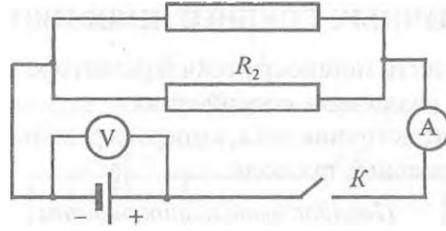
Замкнуть цепь и измерить силу тока  $I$  и напряжение  $U$  на концах параллельно соединенных резисторов. Вычислить сопротивление  $R$ .
