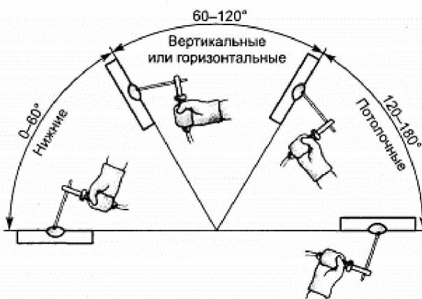
Рисунок 12 - Классификация сварных швов по их положению в пространстве.
