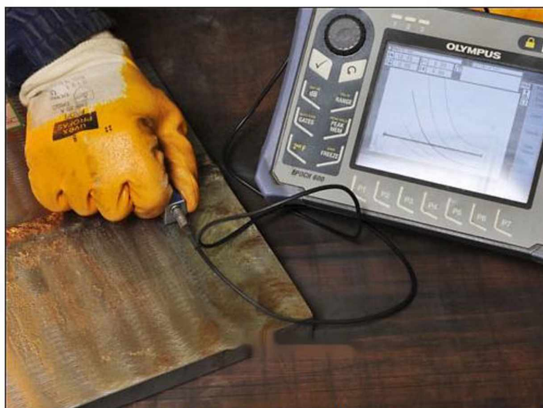
Проверка сварных швов ультразвуковой дефектоскопией
