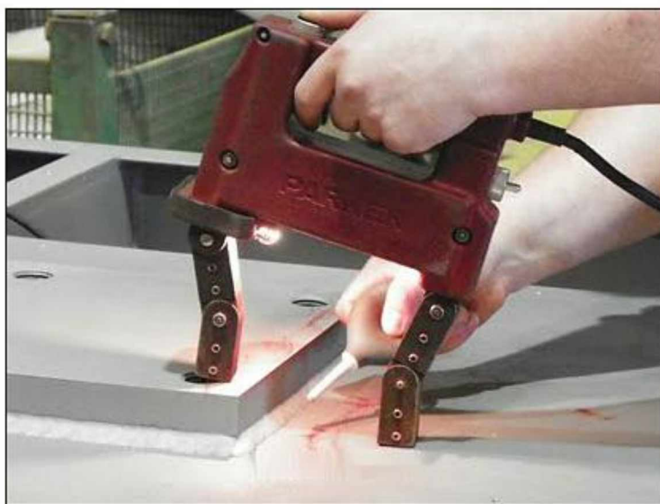
Проверка качества сварных швов магнитной дефектоскопией
