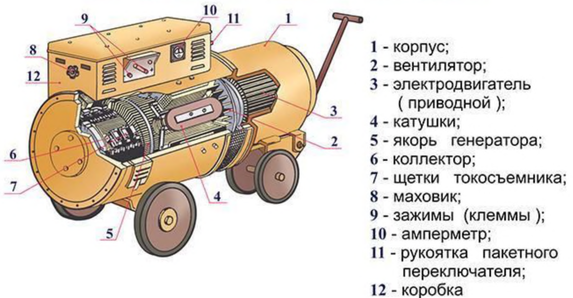
Принципиальная схема многопостового генератора
