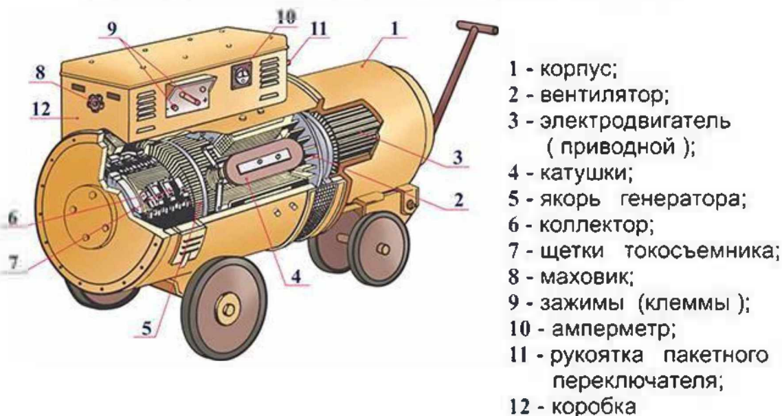
Принципиальная схема многопостового генератора
