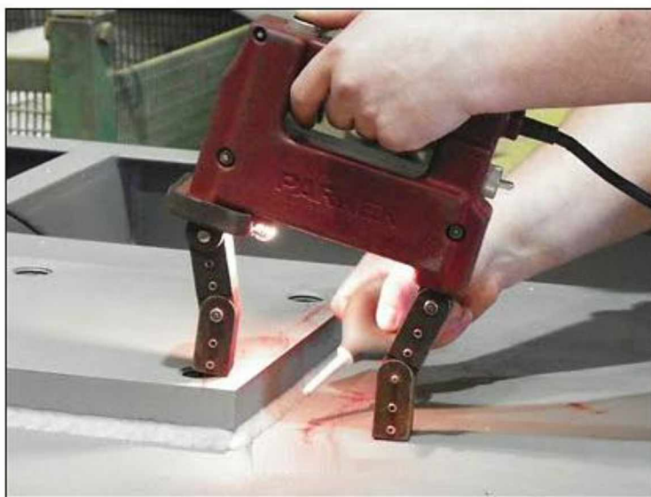
Проверка качества сварных швов магнитной дефектоскопией
