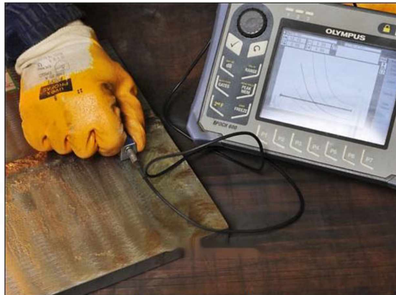
Проверка сварных швов ультразвуковой дефектоскопией
