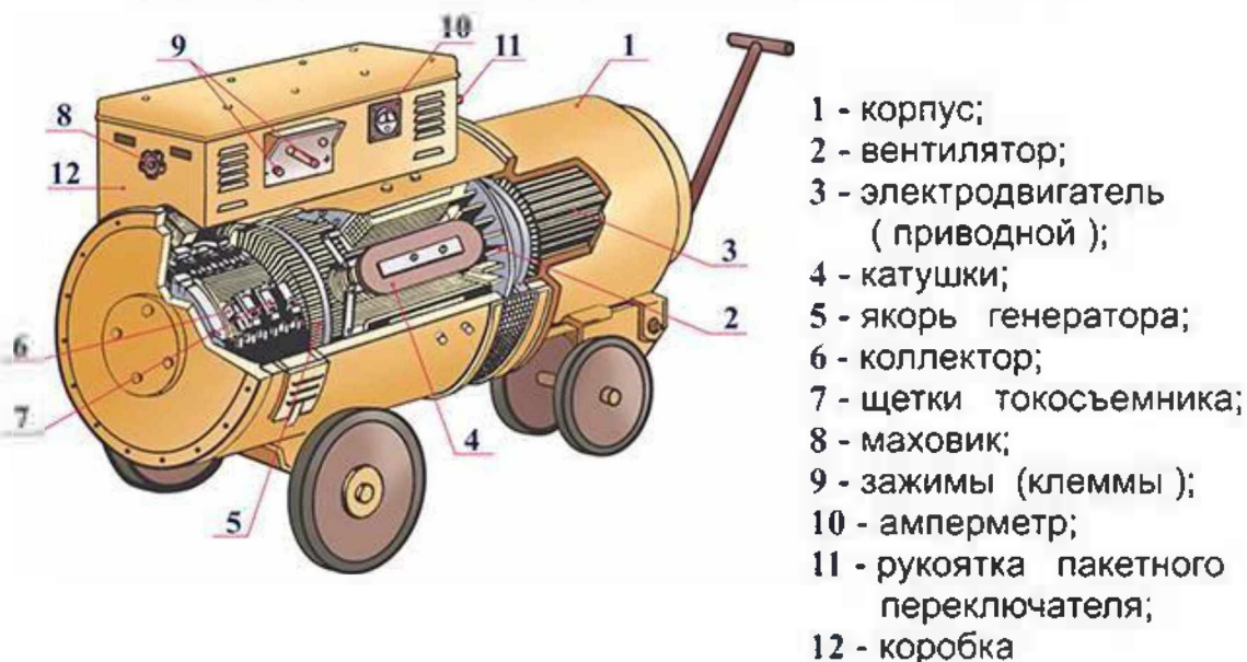
Принципиальная схема многопостового генератора
