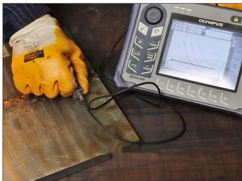
Проверка сварных швов ультразвуковой дефектоскопией
