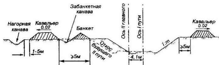
Рисунок 2- Схема расположения двухсторонних кавальеров
