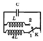
3. Колебательный контур радиопередатчика содержит конденсатор емкостью 0,1нФ и катушку индуктивностью 1 мкГн. На какой длине
